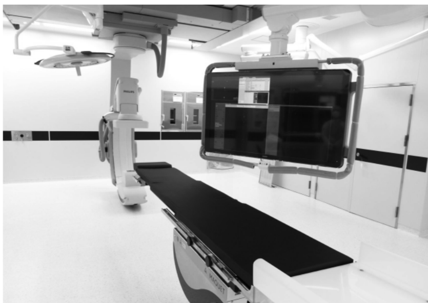
図5 専用テーブルと大型モニタ（2面）
