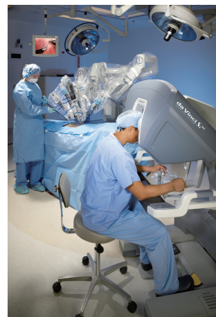
図2 術者コンソールからロボットアームをコントロール
