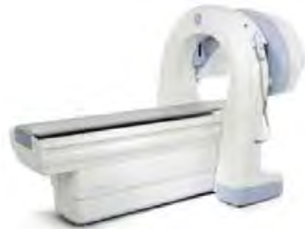
GE社製 Ventri 心臓専用2検出器型ガンマカメラ。 撮像視野は限られるが、感度が高く撮像時間が短縮できます。
